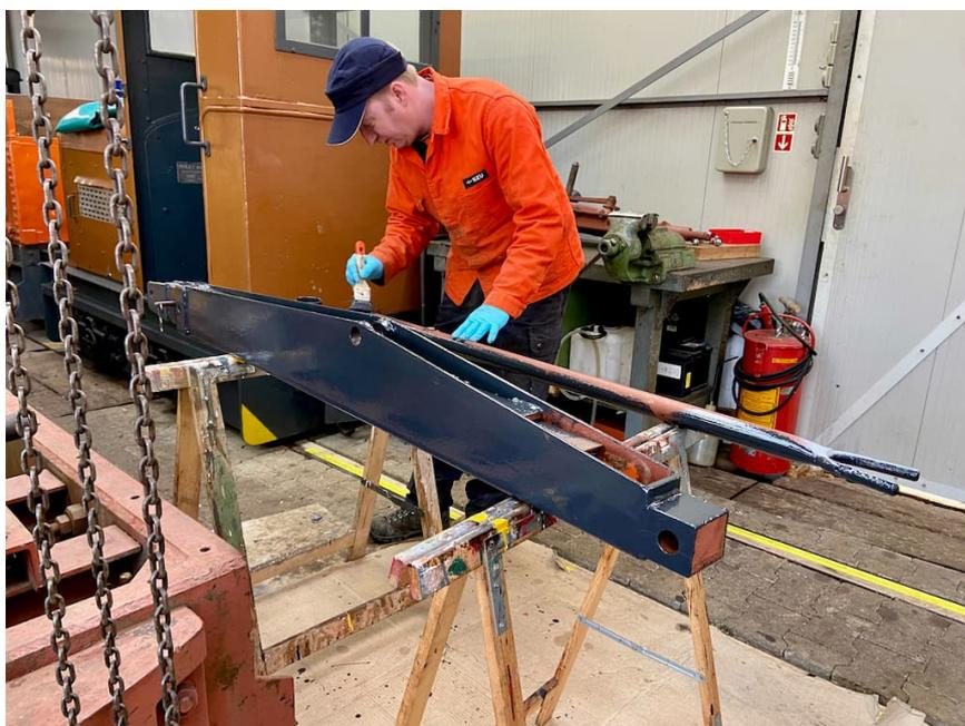
des Krans. Es zeigte sich, dass mit dem bisherigen Rad zu wenig Kraft übertragen werden kann. Deshalb wurde ein grösseres Handrad eingebaut. Der Kran erhielt einen neuen Anstrich und zum Schutz der Mechanik eine Plane. Dank zusätzlichen Schmiernippeln wird auch der Unterhalt künftig einfacher sein.
