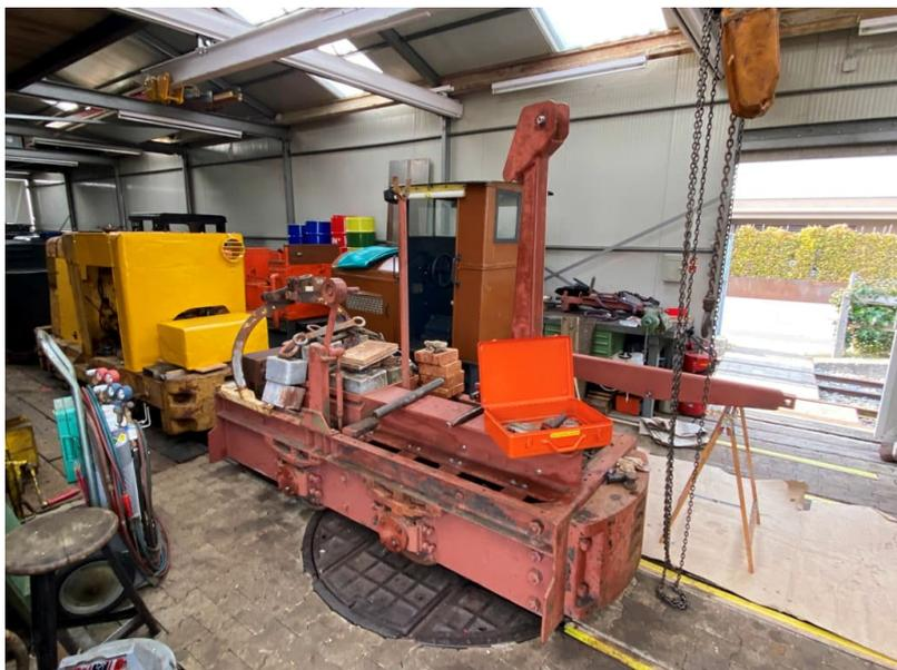
Unsere Kran-Lok (der Kran wurde auf dem Rahmen einer RACO-Lok aufgebaut) macht seit bald 20 Jahre gute Dienste im Gleisbau oder an Orten auf dem Vereinsgelände, an denen etwas Schweres zu heben ist. Leider steht der Kran das ganze Jahr draussen, was der Mechanik zusetzte. Nach und nach klemmte das eine oder andere. Diesen
